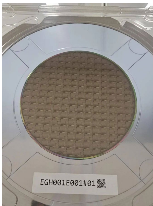
图 4 - 16 珠海华芯微电子有限公司 6 寸 2um 砷化镓 HBT 晶圆
