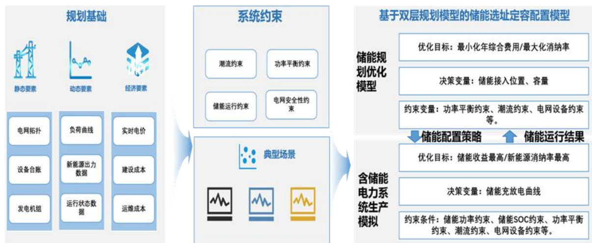
图：储能选址定容规划流程图
