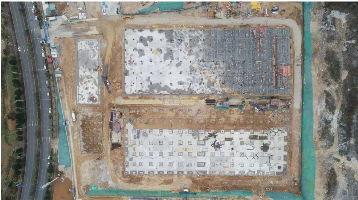
▲南方能源大数据中心建设项目正在实施 1 号楼模板工程和园区道路工程，预计今年 6 月前可完成首栋机楼的封顶工作。（王军皓 摄）
